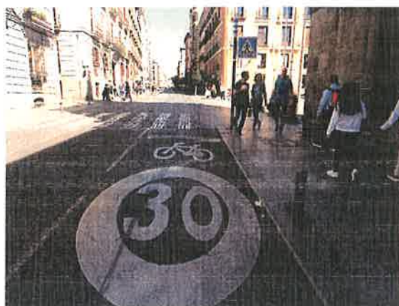
Εικόνα 8: Λωρίδα ποδηλάτου μικτής χρήσης και με όριο ταχύτητας 30 km/h για ασφαλή συνύπαρξη οχημάτων και ποδηλάτων.
