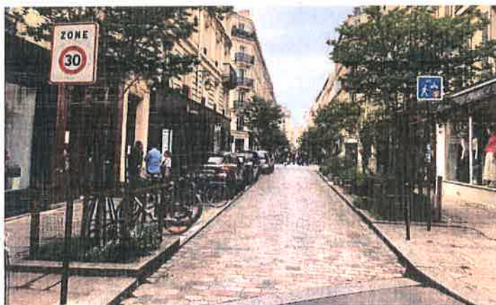
Εικόνα 25: Οδός ήπιας κυκλοφορίας με όριο ταχύτητας 30 km/h και (ελεγχόμενη) παρόδια στάθμευση. Το συγκεκριμένο οδικό περιβάλλον επιτρέπει την αρμονική συνύπαρξη πεζού, ποδηλάτη και οχημάτων.
